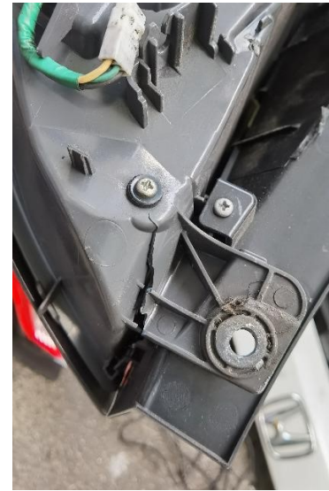
34/44: Taillamp RH - Studs Cracked
