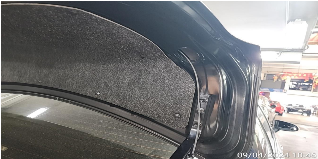
BOOTLID HINGE BENT
