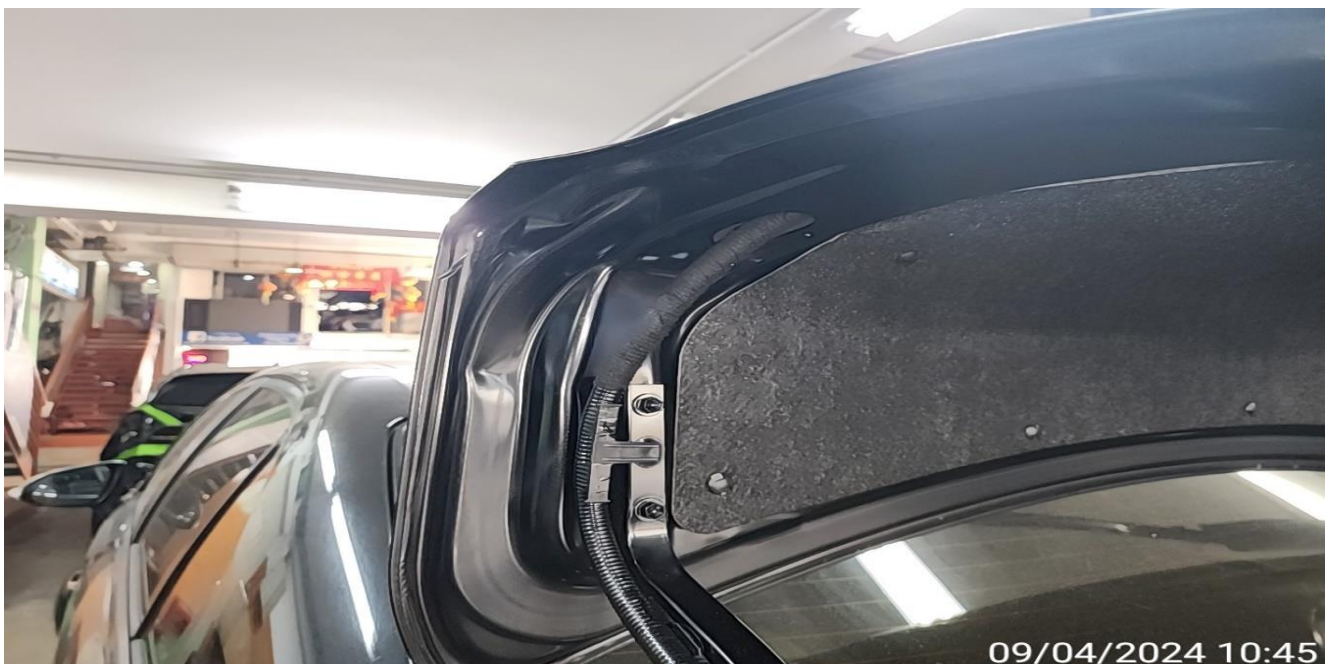
BOOTLID HINGE BENT
